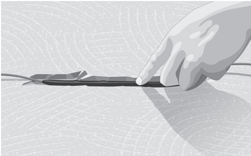
Fig. 2. Spor til skjøt mellom kaldkabel og varmekabel
