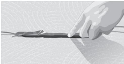
Рис. 2. Паз для соединения холодного и нагревательного кабеля
