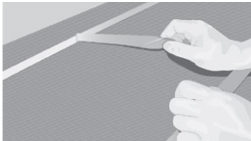
Fig. 6. Disposer du ruban adhésif double face et retirez le support
