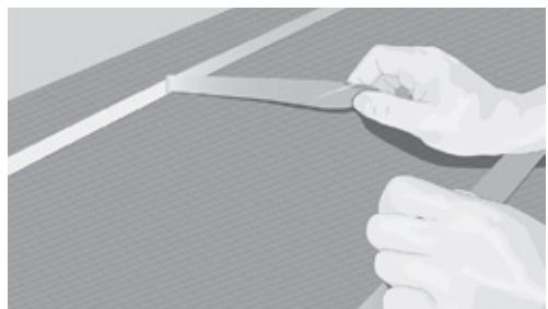
Рис. 6. Размещение двусторонней клейкой ленты и снятие с нее внешнего слоя
