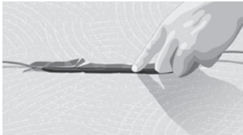
Рис. 3. Паз для соединения холодного и нагревательного кабеля
