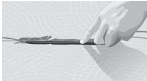
Fig. 3. Rainure pour joint de câble froid et chauffant
